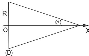
1. Déterminer le champ électrostatique  $\vec{E}(x)$  en un point  $M$  ( $OM=x$ ) de l'axe de révolution ( $Ox$ ) du disque  $(D)$ .
