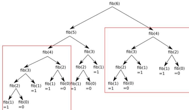
On pourrait donc grandement simplifier le calcul en calculant une fois pour toutes fib(4), en "mémorisant" le résultat et en le réutilisant quand nécessaire:
