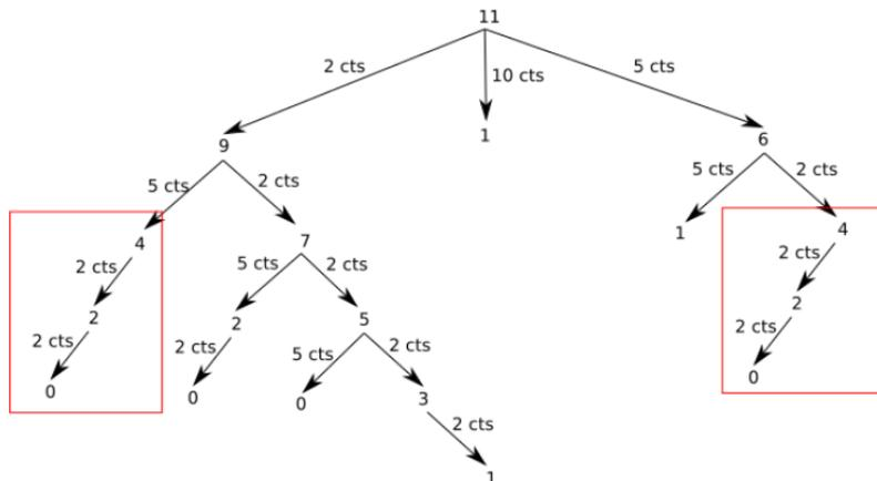
Il va donc être possible d'appliquer la même méthode que pour Fibonacci: la programmation dynamique. À noter que dans des cas plus "difficiles à traiter" comme 1,71 euro, on va retrouver de nombreuses fois exactement les mêmes calculs, il est donc potentiellement intéressant d'utiliser la programmation dynamique.
